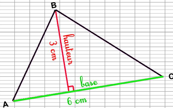
$$\text{aire du triangle quelconque} = (\text{hauteur} \times \text{base}) : 2$$
